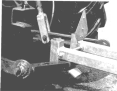
Ackerschiene in Ausziehdoublehaken einhängen und Stativ ausziehen.
