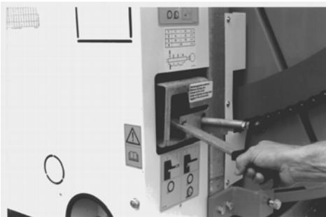
Getriebschalthebel in Stellung „PE-Rohrauszug“ bringen. Der Schalthebel wird durch eine Feder nach oben gedrückt und verrastet.
