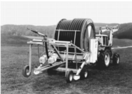
Beim Transport soll die Haspel in Fahrtrichtung gedreht und mit dem Vorstecker gesichert sein. Das Stativ, der Deichselstützfuß sowie die beiden hinteren Gerätestützen müssen hochgehoben bzw. eingefahren sein. Den Rainstar bei seitlichem PE-Rohrabzug am Feldrand rechtwinkelig zum vorgesehenen Beregnungsstreifen abstellen und vom Traktor abhängen.
