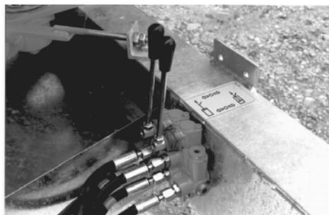
Das Ein- u. Ausfahren der Geräteabstützung wird mit der OPTION „Steuerventilblock - Abstützung“ wesentlich erleichtert.
