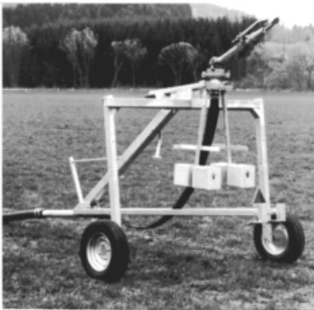
Durch die hohe Bauweise der Radstative symmetrisch sowie asymmetrisch sind diese besonders kulturschonend (Radstativ asymmetrisch ist Option). Die Spurweite ist stufenlos verstellbar und ermöglicht die Anpassung an jeden Reihenabstand. Die Verstellung erfolgt über den Rahmenträger symmetrisch.
