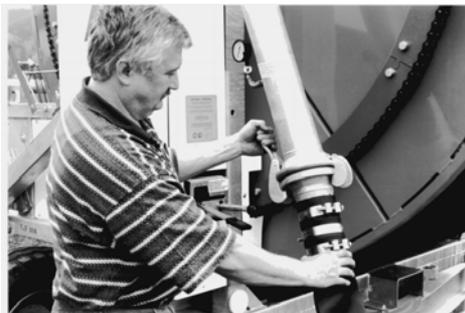
Den Druckschlauch ankuppeln. Die Wasserzufuhr öffnen.
