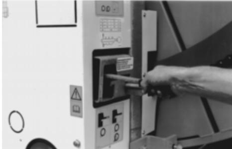
... und durch vorsichtiges dosiertes nach unten drücken des Abschalthebels, das PE - Rohr entspannen.
