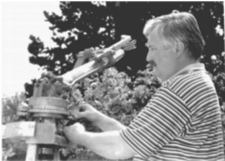
Beim Weitstrahlregner den Sektor einstellen (ca. 220° für volle Streifenbreite). Weitere Hinweise siehe eigene Betriebsanleitung für den Regner. Der WINDGUN kann durch Verstellen des Strahlerhebungswinkels auf die vorherrschenden Windverhältnisse abgestimmt werden.
