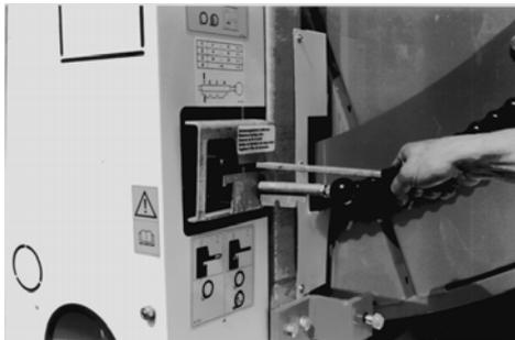
Wenn der Betriebsdruck erreicht ist und beim Weitstrahlregner nur mehr Wasser ohne Luft einschlüsse im geschlossenen Strahl austritt, Getriebeschalthebel in Stellung „PE-Rohreinzug“ bringen.
