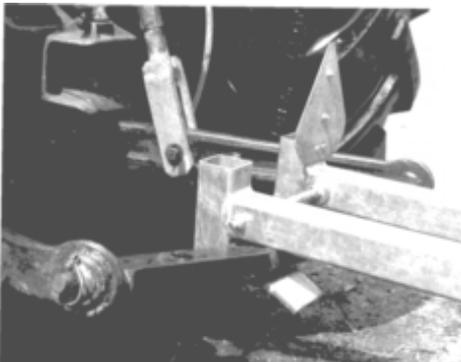
Zum leichteren Ausziehen des PE - Rohres sind die Stative mit einem Ausziehdoublehaken ausgestattet. Die Ackerschiene des Traktors wird in diesen Haken eingehängt und das PE-Rohr ausgezogen. Beim Schwenken der Rohrhaspel, sowie beim Umstellen in eine andere Aufstellposition des Rainstars muß das Stativ in die Endstellung am Rainstar eingezogen sein.
